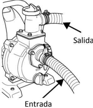
Coloque agua en el orificio de cebado de la bomba antes de dar marcha al motor
