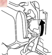
Para encender la bomba: Coloque la palanca del ahogador a la posición cerrado. (Hacia arriba).
