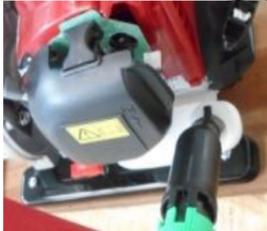
Coloque Gasolina nueva al tanque sin exceder el cuello del tanque a fin de que esta no se derrame
