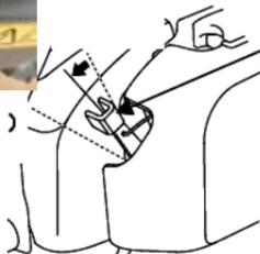
Mueva la palanca del acelerador hacia la izquierda a la mitad del recorrido.
