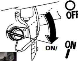
Gire el interruptor del motor a la posición ON
