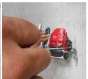
Tire un poco de la empuñadura del arrancador hasta notar resistencia y luego tire con fuerza
