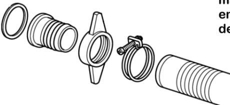
Conecte las mangueras de entrada y de salida de la motobomba.
